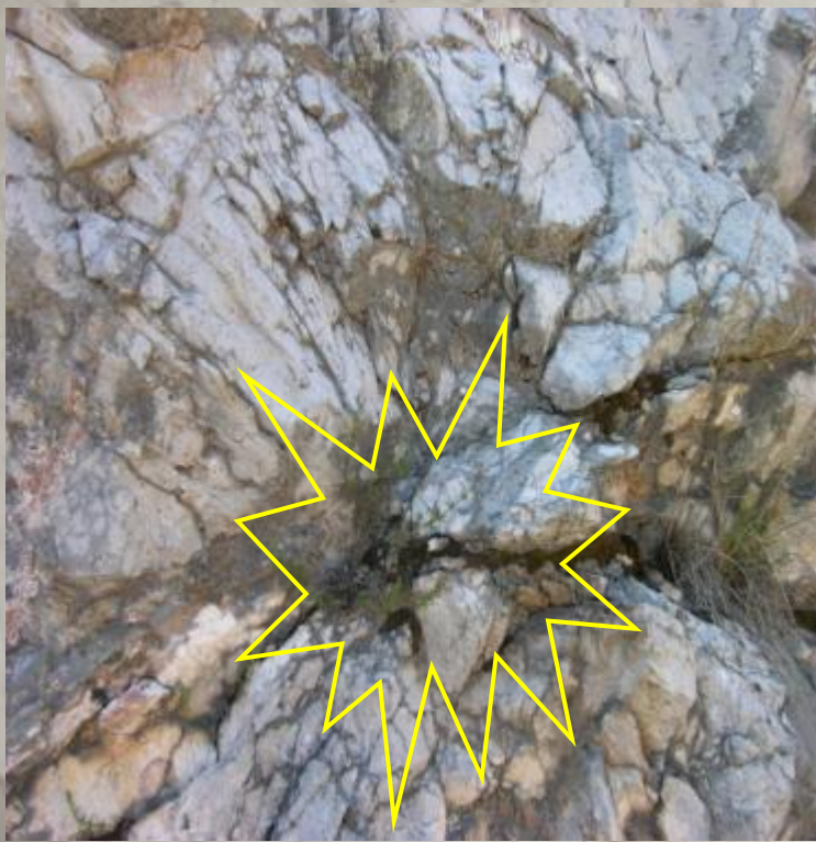
Effetti delle tecniche esplosive: “Rosoni”.
